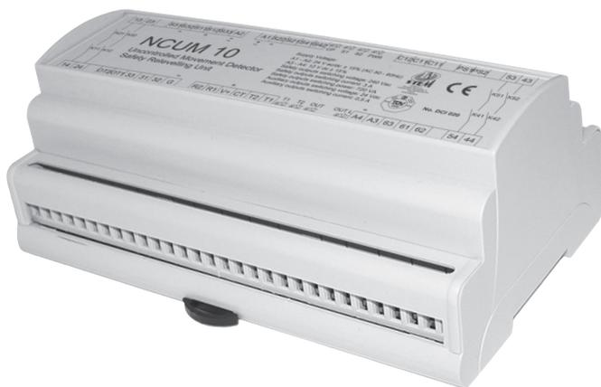
La centralina NCUM10 è un dispositivo di sicurezza utilizzabile per rilevare il movimento incontrollato di ascensori in accordo con la EN 81-1:1998+A3:2009, EN 81-2:1998+A3:2009. Il funzionamento di questo modulo si basa sull'utilizzo di relé di sicurezza a contatti guidati.
